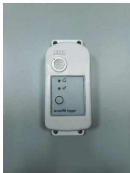
Fig. 1 - Data logger (HOBO) per il monitoraggio continuo della temperatura del suolo
