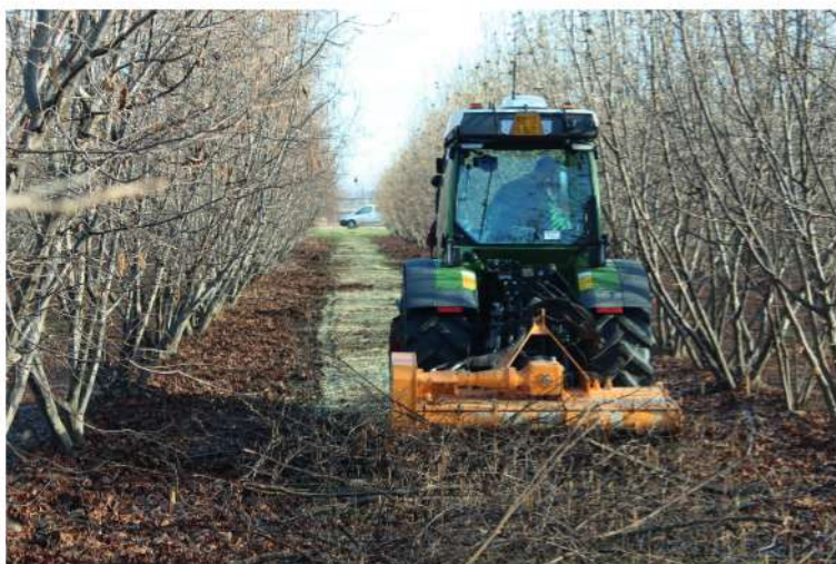
Fig. 8 – Trincia forestale in azione
