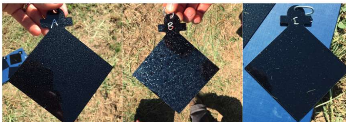
Fig. 1 - Supporti in polietilene del kit "DROP'IN" utilizzati nel sito di Ponti alle seguenti altezze: A - alto 2m, B - basso 1.2m, I - interno 1.7m.
