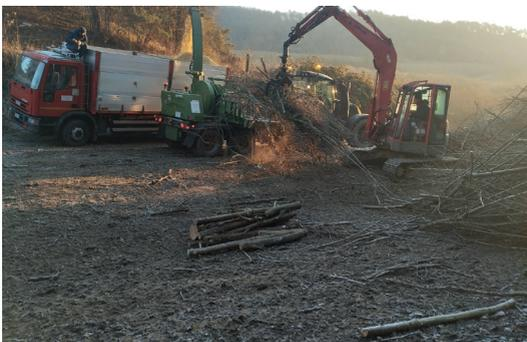
Fig. 7 -Operazioni di cippatura di legno di potatura
