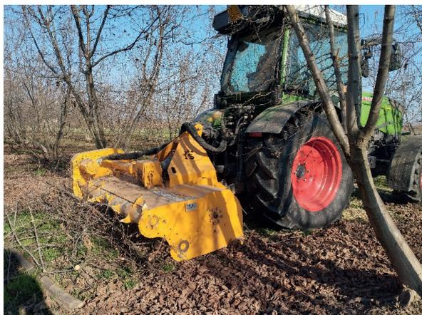
Figura 9. Trincia forestale in azione in campo
