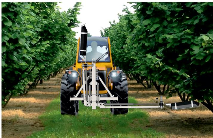
*La **barra laterale per il trattamento sottofila** è la soluzione perfetta per un controllo mirato delle infestanti e una gestione ottimale del terreno nei nocciuoleti. Progettata per garantire **precisione ed efficienza**, consente un'**applicazione localizzata dei prodotti fitosanitari**, riducendo sprechi e impatti ambientali.*
