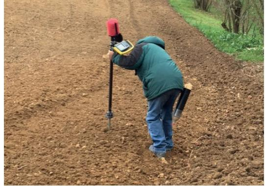
Figura 5. Tracciamento con attrezzature GPS
