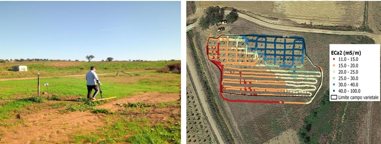
Il campo viene rilevato tramite sensore di rilevamento prossimale ad induzione elettromagnetica per la cartografia della conducibilità elettrica apparente (ECa).
