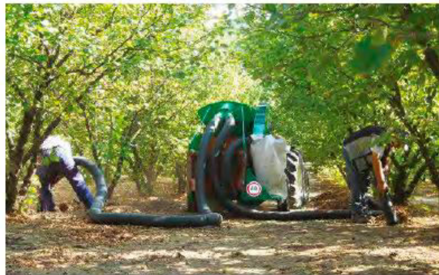
▲ Fig. 8 - La raccolta avviene tradizionalmente con macchine portate o trainate, più adatte ad aziende di piccole dimensioni per il minor costo di acquisto. Nella foto, aspiratrice trainata al lavoro.
