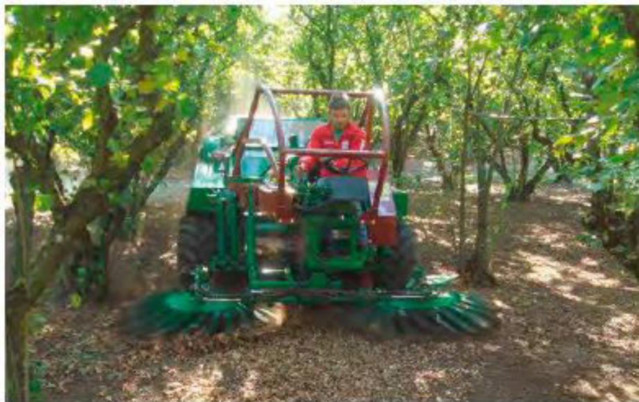
▲ Fig. 7 - Raccogliatrice semovente Semek. La raccolta avviene con spazzole di gomma che raccolgono il prodotto da terra e lo sollevano. Internamente, altri dispositivi consentono la pulizia, la cernita e lo stoccaggio in carrelli o in sacchi.
