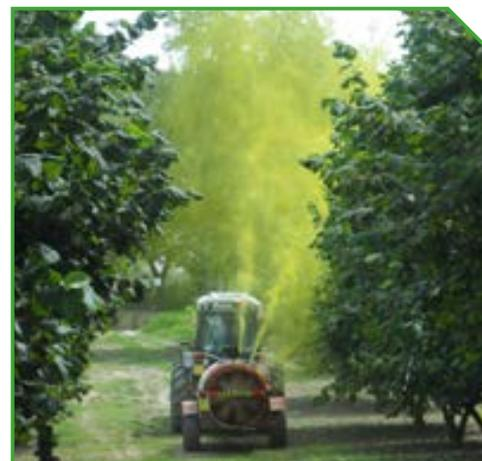
Fase di distribuzione con tracciante colorato (prova Agrion - DISAFA)
