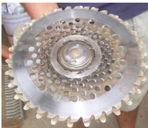
**Figura 4.2 - Lama in acciaio specifica per la spollonatura, settembre 2010**
