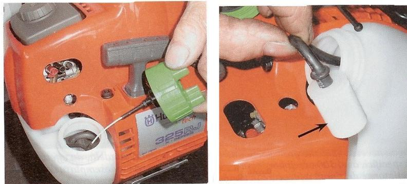
**Figura 4.13 - Tappo serbatoio e filtro del tubo aspiratore della benzina**
