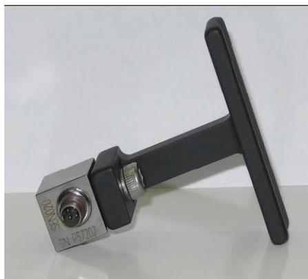
**Figura 6.5 - Adattatore a “T” collegato al trasduttore**
