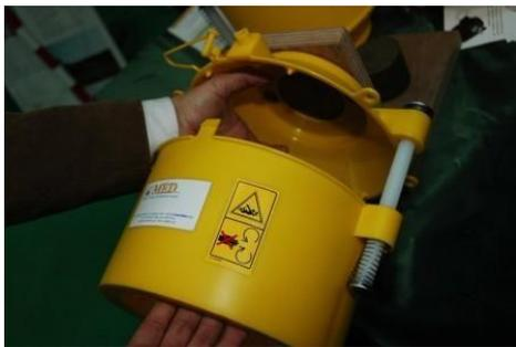
**Figura 8.15 –Protezione sfilabile con molle di contrasto**
