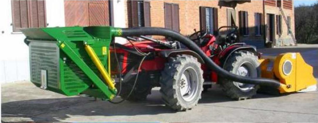
**Figura 5.20 - Macchina raccoglitrice Rivmec, trattore A. Carraro guida reversibile mod. TRX 7400, cassone per stoccaggio e scarico (gentile concessione ditta Chianchia)**
