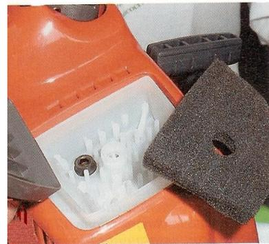
**Figura 4.12 - Sostituzione filtro carburatore**
