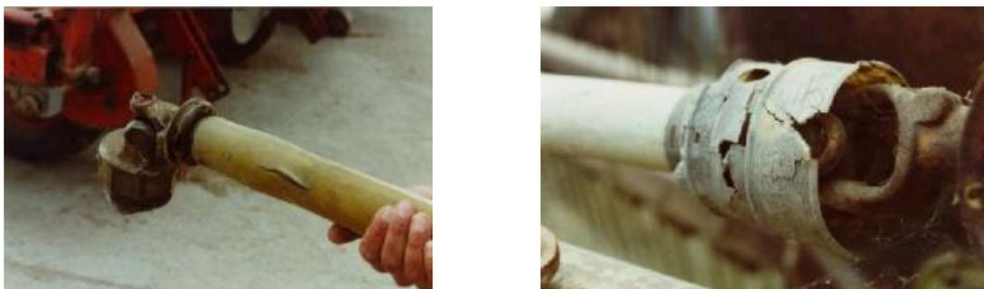
**Figura 8.23 - Colpi, tagli, invecchiamento atmosferico, degli alberi cardanici**
