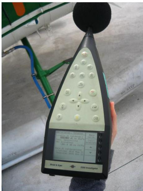
**Figura 6.9 - fonometro integratore e microfono di precisione Brüel & Kjaer**
