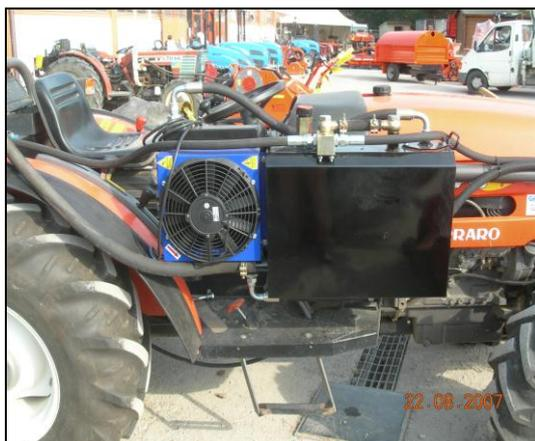
**Figura 5.19 - Particolare kit idraulico JOLLY 1800 montato su trattore Carraio**
