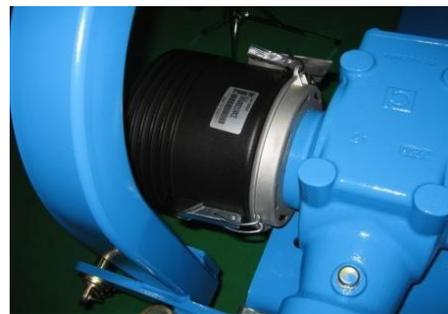
**Figura 8.16 - Protezione sfilabile con cerniere di blocco**
