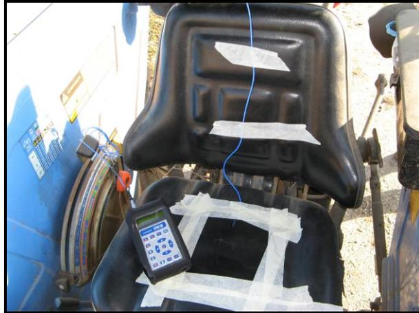
**Figura 6.7 : Accelerometro per il corpo intero**
