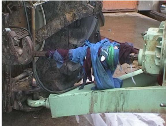
**Figura 8.12 - Esempio di albero cardanico non protetto**
