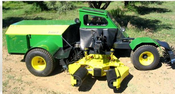
**Scuotitore semovente da tronchi con testata montata su braccio estensore ortogonale alla fila**
