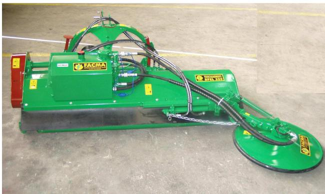
Disco Interfilare Idraulico con serbatoio, pompa, distributore, innesti idraulici per aggancio e sgancio del disco.
