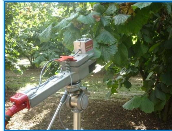
Analizzatore di scambi gassosi LcPro+
