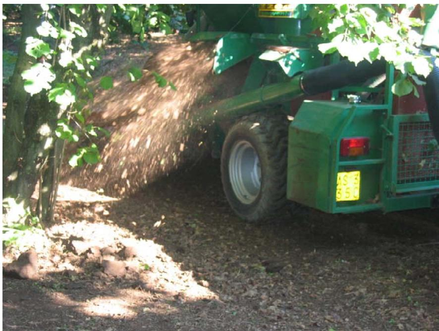
*Foto 22 Particolare della Semovente Cimina 200 (valvola espulsione impurità pesanti) durante la raccolta.*
