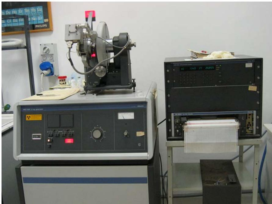
*Foto 9 diffrattometro del laboratorio di Igiene Industriale.*
