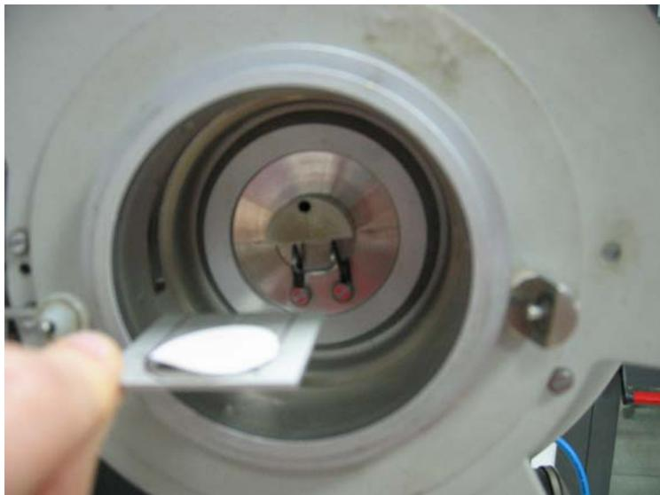
*Foto 11 posizionamento del filtro nel diffrattometro.*
