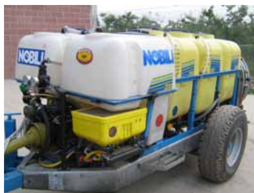
Fig. 2. Irroratrice multiserbatoio per prove parcellari con la quale è possibile variare i parametri operativi senza scendere dal trattore.
