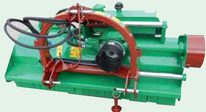
Il modello BPEL è indicato per la trinciatura di **manti erbosi, sarmenti e pietre fino a 6 – 7 cm di diametro nei frutteti**. L'alta velocità di rotazione delle mazze permette un ottimale sminuzzamento dell'erba e dei sarmenti. L'attacco è disponibile spostabile manualmente o idraulicamente. Applicabile a trattori con potenza compresa tra 25 e 100 CV.
