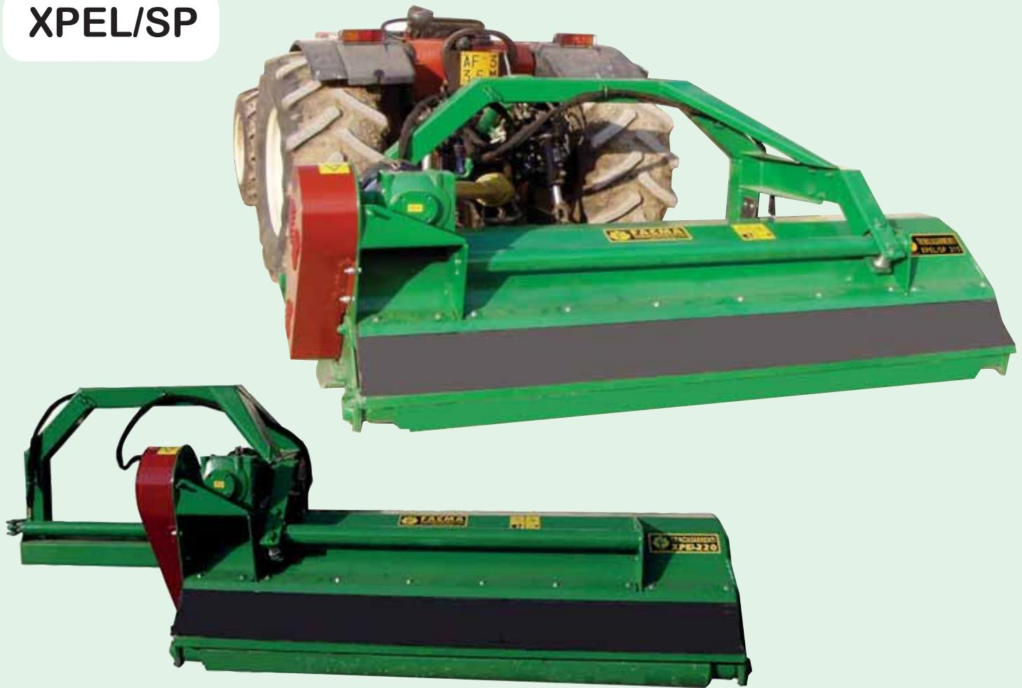
Il modello XPEL viene costruito anche nella versione XPEL/SP, dotato di un dispositivo di spostamento laterale idraulico, completamente fuori dalla carreggiata, che permette di trinciare sotto le chiome più basse, rimanendo con il trattore nell'interlinea. È dotato di protezioni antinfortunistiche anteriori in gomma telata. Applicabile a trattori con potenza compresa tra 70 e 120 CV.
