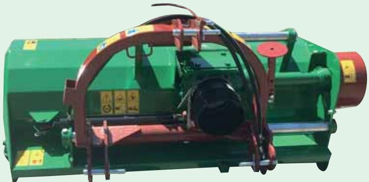
Il modello XPEL è adatto alla trinciatura in terreni sassosi, irregolari e per la manutenzione di zone boschive. **La struttura nella totalità dei suoi componenti è particolarmente robusta**, tale da trinciare residui di potatura di grandi dimensioni (circa 10 - 15 cm di diametro) e pietre muovibili fino a 25 cm di diametro. L'attacco è disponibile spostabile manualmente o idraulicamente. Applicabile a trattori con potenza compresa tra 45 e 120 CV.
