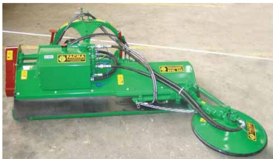
■ **Disco Interfilare Idraulico con serbatoio, pompa, distributore, innesti idraulici per aggancio e sgancio del disco.**
