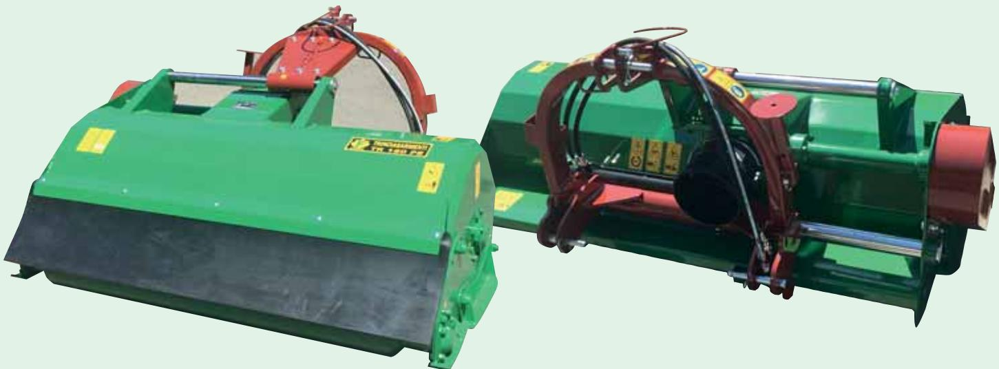
Il modello PEL è adatto alla trinciatura in frutteti ed in pieno campo (paglia, stocchi di mais, ecc.). Viene utilizzato per trinciare erba, sarmenti, pietre muovibili e residui di potatura fino a 10 cm di diametro. **La cofanatura alta e la forma dei martelli conferiscono una grande velocità di smaltimento del prodotto sminuzzato.** L'attacco è disponibile spostabile manualmente o idraulicamente. Applicabile a trattori con potenza compresa tra 40 e 100 CV.
