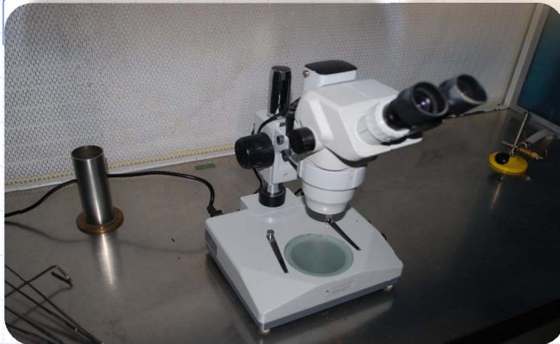
**stereomicroscopio ottico su cappa a flusso laminare**
