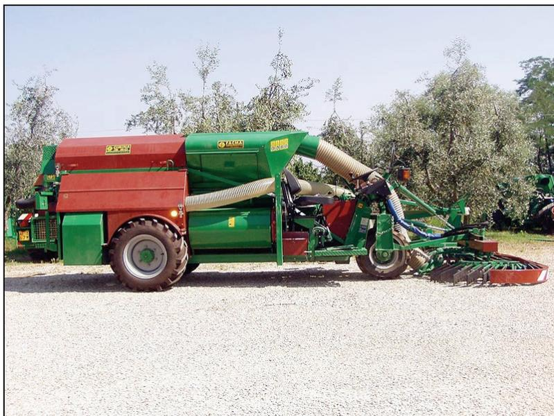
Foto 18 - Aspiratrice semovente FACMA mod. C 380 S
