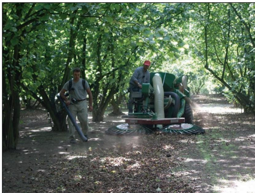
Foto 37 - Cimina 300 Semovente durante la raccolta in Langa (CN)
