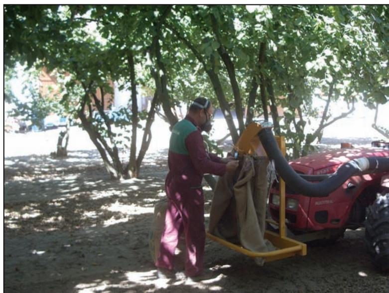
Foto 39 – Operazione di sostituzione sacchi sulla macchina
