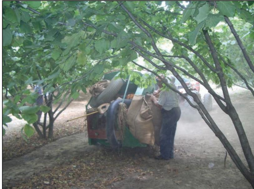
Foto 43 – Operazione di sostituzione sacchi nell'azienda Busca
